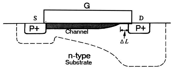
$$V_{SD} > V_{SG} + V_{TP} (>0)$$
