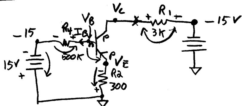
$$0 = (+15V) + I_B R_4 + 0.7 + I_E R_2$$
